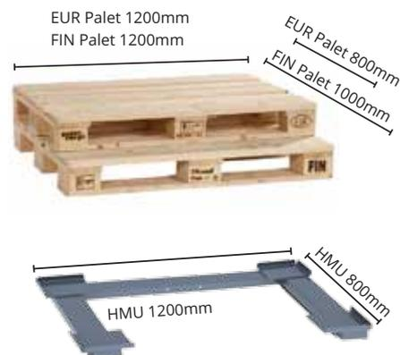
Estantes para contenedores con patas HMU: incluyen placas con bordes en las esquinas para que no se muevan y para reforzar las cargas puntuales de las patas.
